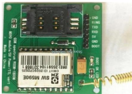
Рис. 7. GSM-модуль M590
