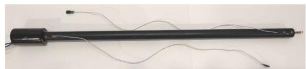
Рис. 5. Зовнішній вигляд теплової трубки з підсилювачем потужності та термодавачами.
