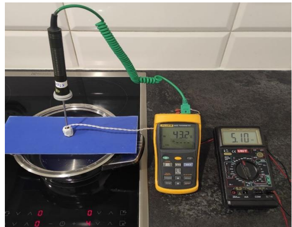
Рис. 4. Тарування терморезисторів у водяному термостаті.
