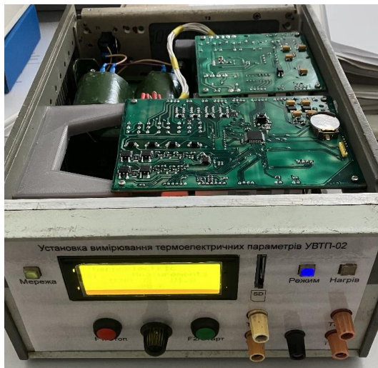
Рис. 4. Блок керування (а) та загальний вигляд установки (б).
