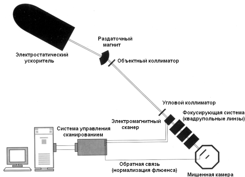
Рис. 7. Схема формування зфокусованого пучка легких іонів середніх енергій у ядерному скануючому мікрозонді для цілей технології P-beam writing.
