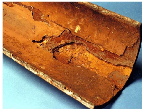
Рис. 1. Корозійні пошкодження внутрішньої поверхні газопроводу, спричинені дією рідини, яка збирається в його порожнині.
