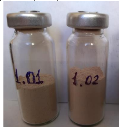
Рис. 4. Зразки нанокремнезему, модифікованого лігніном, до (зразок 1.01) та після (зразок 1.02) зшивання.
