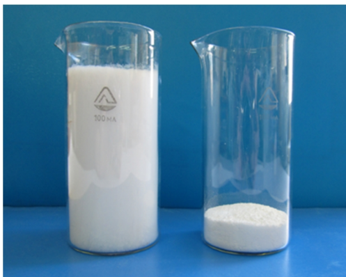
Рис. 2. Порівняння об'ємів вихідного нанокремнезему (1) і «Денсилу» (2) при однаковій вазі зразків 5 г.
